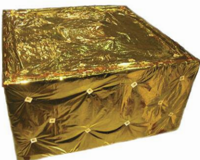
Tissu MLI protégeant les satellites 1970 © CNES
