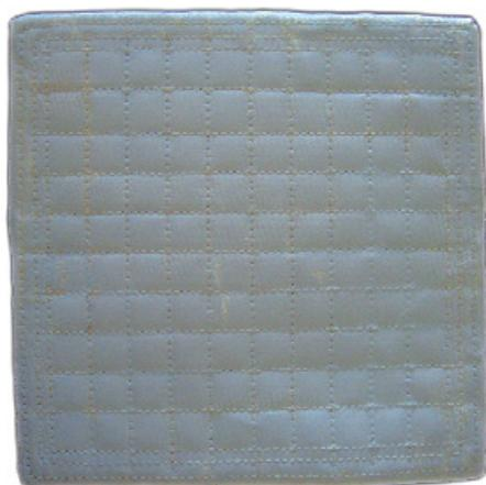
Echantillon de matelas isolant en tissu de quartz.
