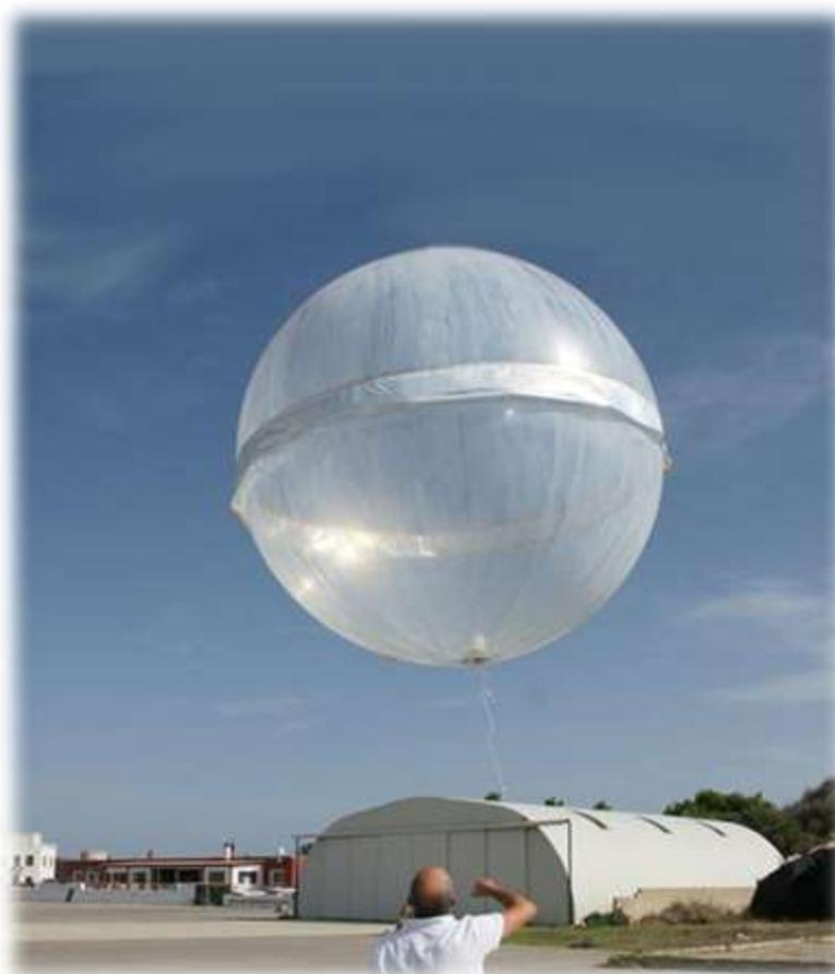
**Figure 4: BPCL, Ballon Pressurisé Couche limite**
